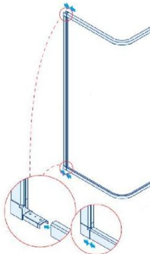
**Pasul 5 - Instructiuni de montaj - Introduceti usa cabinei de dus pe sina superioara respectiv inferioara. Procedati la fel si cu cealalta usa.**
