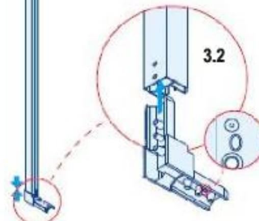
**Pasul 4 - Instructiuni de montaj- Introduceti sinele superioara si inferioara in coltarele montate pe stalpul lateral.**
