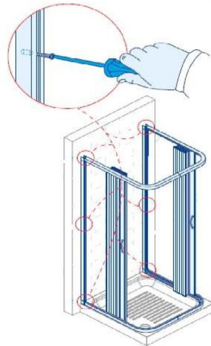
**Pasul 10 - Instructiuni de montaj - Tot in interiorul cabinei de dus, pe stalpii din dreapta respectiv stanga, unde se inchide cabina, montati prin clipsare profilele ca in figura.**
