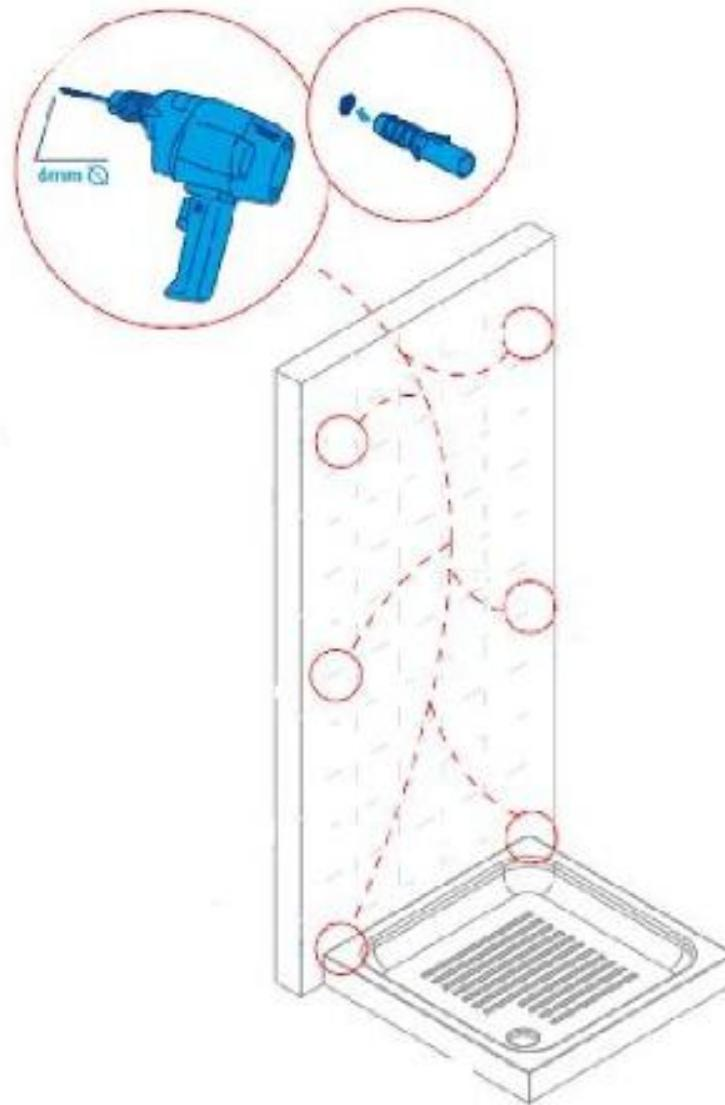
**Pasul 9 -Instructiuni de montaj - Fixati cabina de dus pe perete cu suruburile furnizate.**
