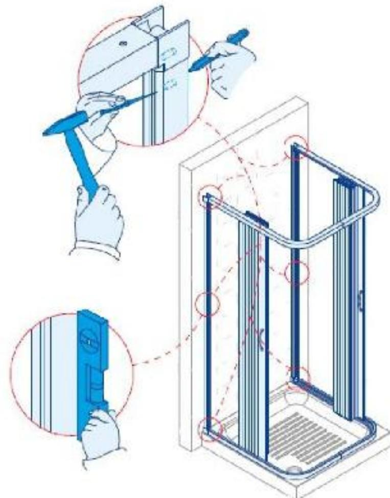
**IMPORTANT:** Verificati verticalitatea profilelor cu o nivelă, functionarea cabinei depinde de asta.
