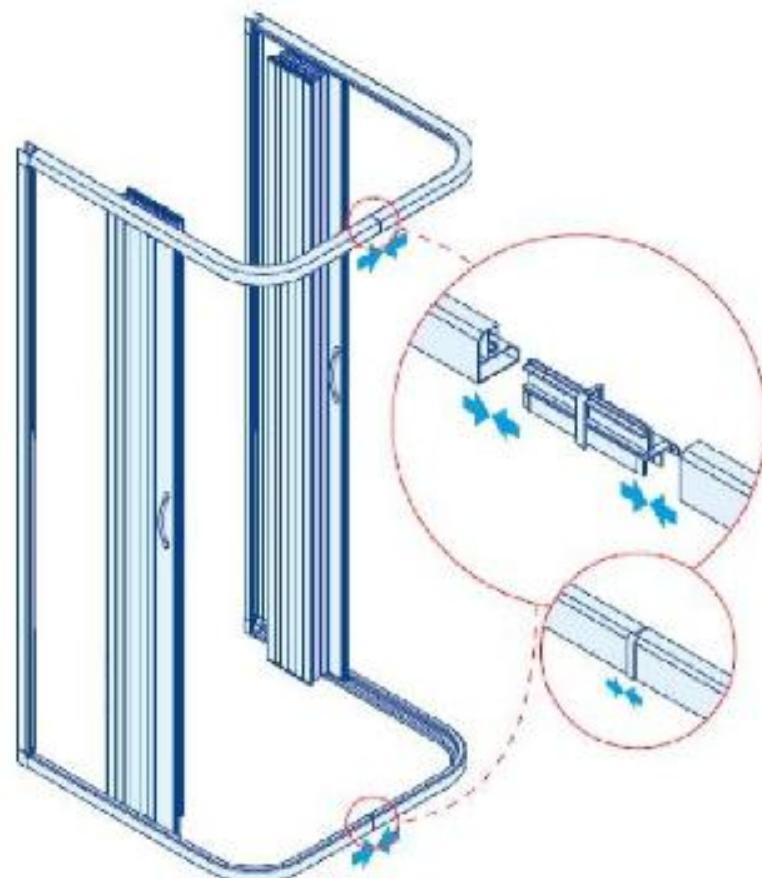
**Pasul 7 - Instructiuni de montaj -** Cabina astfel asamblata se introduce in golul destinat ei precum in desenul de mai jos si se dau semne pentru dibluri prin gaurile din profilele laterale.
