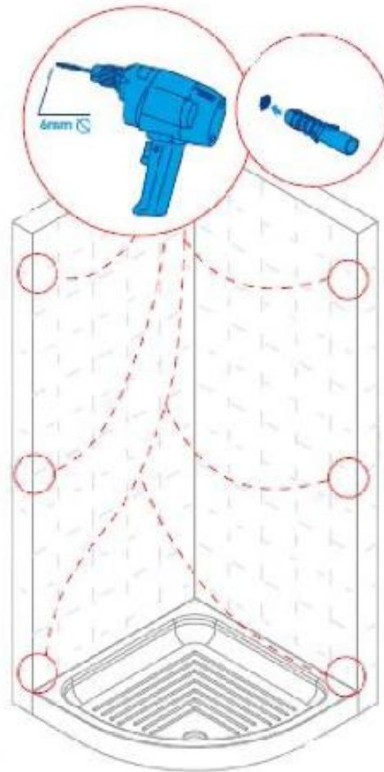
**Pasul 9 - Instructiuni de montaj - Fixati cabina de dus pe perete cu suruburile furnizate.**
