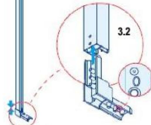
**Pasul 4 - Instructiuni de montaj-** Introduceti sinele superioara si inferioara in coltarele montate pe stalpul din stanga (in cazul in care cabina se deschide din dreapta spre stanga) sau dreapta ( daca cabina se deschide de la stanga la dreapta).
