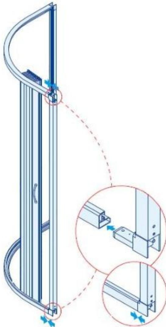
**Pasul 7 - Instructiuni de montaj - Cabina astfel asamblata se introduce in golul destinat ei precum in desenul de mai jos si se dau semne pentru dibluri prin gaurile din profilele laterale.**
