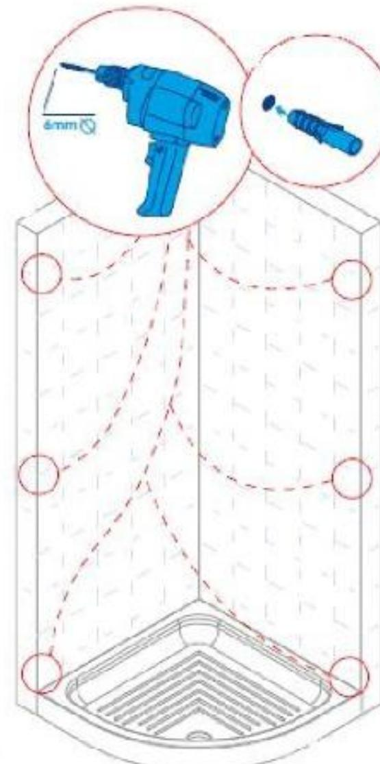
**Pasul 10 - Instructiuni de montaj - Fixati cabina de dus pe perete cu suruburile furnizate.**
