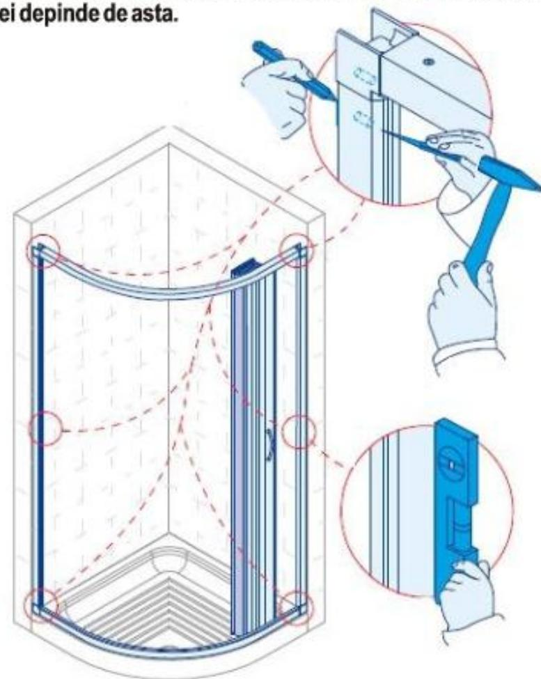
**Pasul 8 - Instructiuni de montaj - Indepartati cabina si cu ajutorul unei bormasini dati gauri si montati diblurile.**
