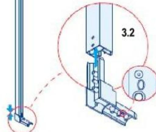
**Pasul 4 - Instructiuni de montaj- Introduceti sinele superioara si inferioara in coltarele montate pe stalpul din stanga (in cazul in care cabina se deschide din dreapta spre stanga) sau dreapta ( daca cabina se deschide de la stanga la dreapta).**
