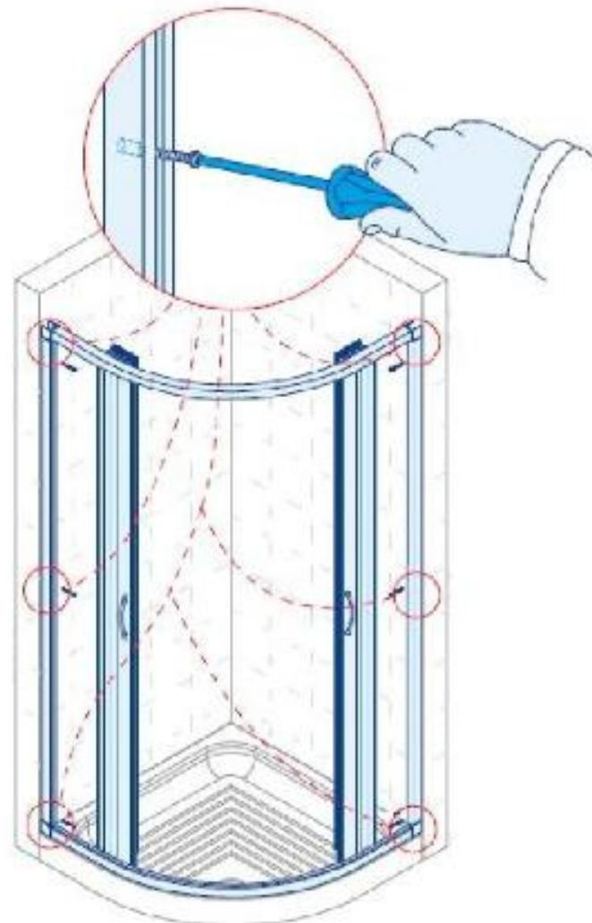
**Pasul 11 - Instructiuni de montaj - Tot in interiorul cabinei de dus, pe stalpii din dreapta respectiv stanga, unde se inchide cabina, montati prin clipsare profilele ca in figura.**
