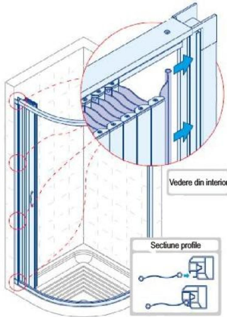
**Pasul 11 - Instructiuni de montaj - Tot in interiorul cabinei de dus, pe stalpul unde se inchide cabina, montati prin clipsare profilul ca in figura.**
